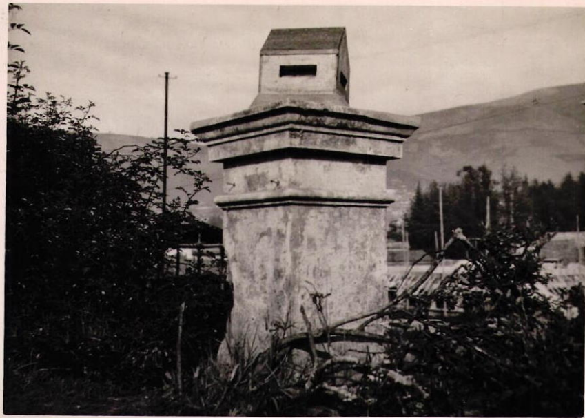
(Fotografía No.1) Anemopolinómetro con dispositivos para recoger pólen en las cuatro direcciones cardinales.
